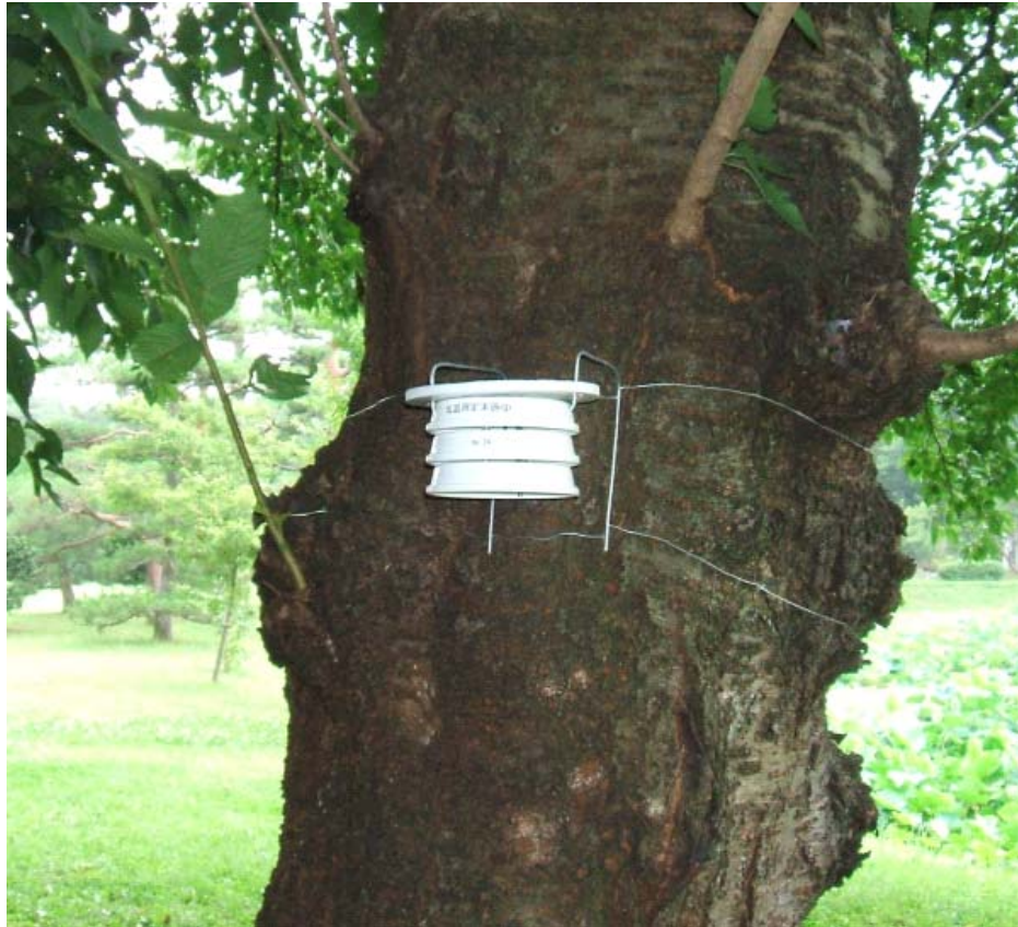
図 3-7. 自作簡易百葉箱設置の様子
