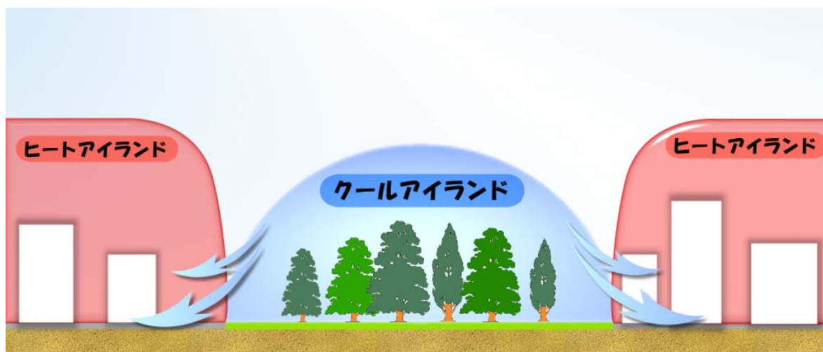
図 3-1. クールアイランド形成と冷気しみ出しの模式図
