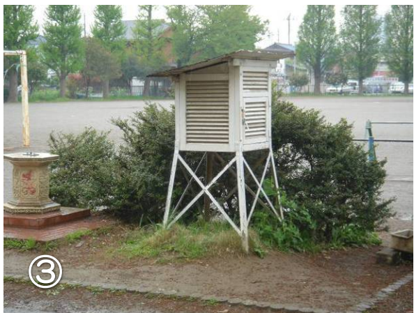
図 4 小学校の百葉箱 (①～③) と温度データロガーの設置 (④) 状況
