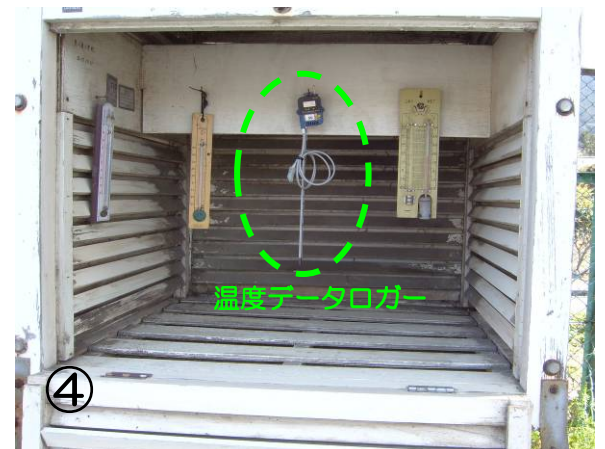
図 4 小学校の百葉箱 (①～③) と温度データロガーの設置 (④) 状況
